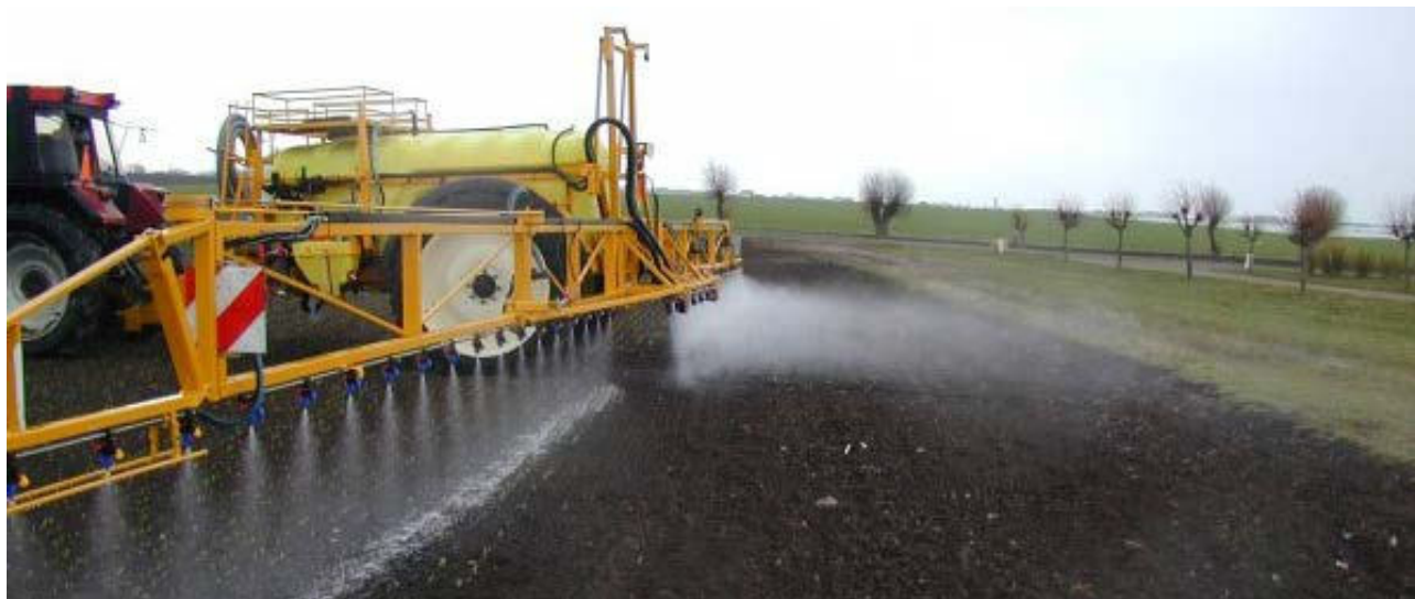
Spruta med injektormunstycken på den närmaste rampdelen och vanliga spaltspridare på den bortre rampdelen. Foto: Magnus Sandström
