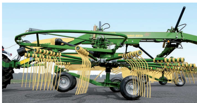
Böjd pinne. Testet visade att den mer böjda räfs핀nen minskade spillet av grönmassan.
