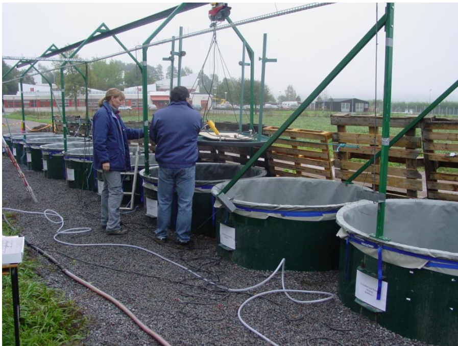
Figur 5. JTI:s anläggning för mätning av växthusgaser från lagrad flytgödsel.
