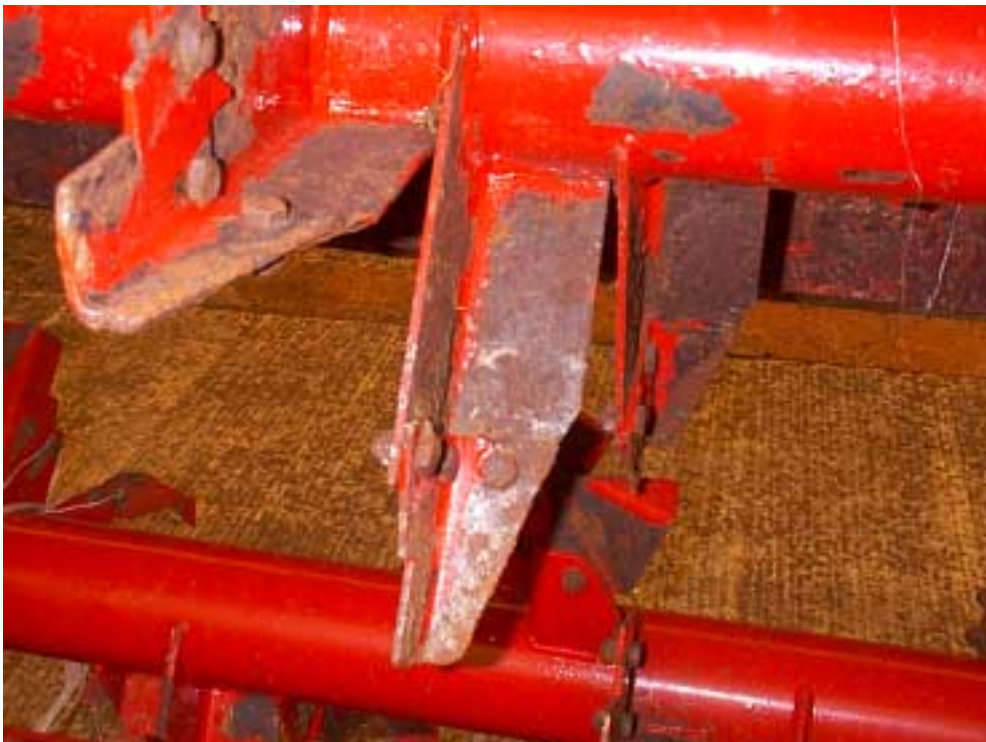
Bild 5. Spridarvingarna på den övre valsen skars av så att de smalnar av mot ytterändan.
